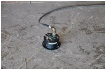
a) Sensor para prueba de traslación
