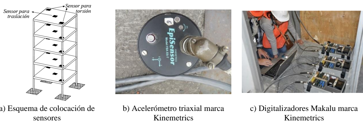
Figura 7. Diseño de pruebas de vibración ambiental e instrumentación durante la prueba
