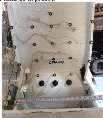
b) Estado típico de la conexión CPA al final de la prueba
